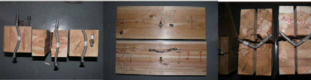
日本柳杉螺栓和销连接力学试验典型破坏模式
