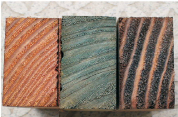
防腐剂中的铜元素在日本主要树种木材中的渗透情况（从左至右依次为日本落叶松、日本扁柏、日本柳杉）
