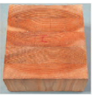
胶缝完整性试验后的日本柳杉集成材试件
