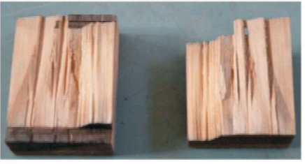
胶粘耐久性试验后的日本柳杉集成材试件的破坏状态
