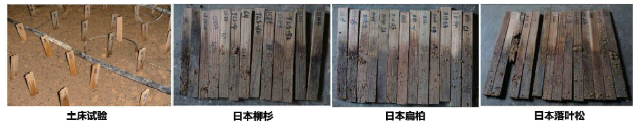
土床试验 3 年试件天然耐腐菌表现
