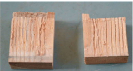
胶粘能力试验后的日本柳杉集成材试件的破坏状态
