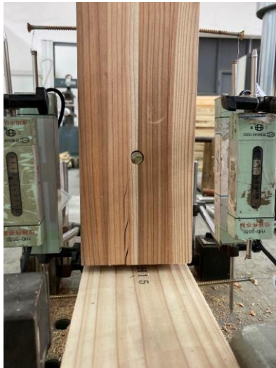
图6 LZL-P1-1破坏阶段(侧面)
