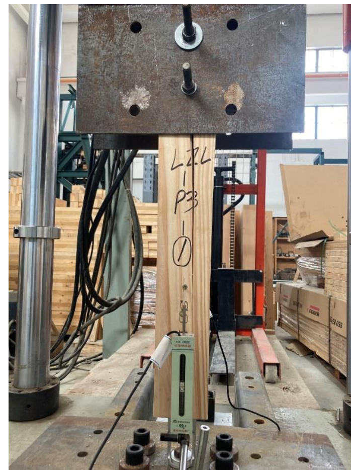
图13 LZL-P3-1破坏阶段（卸载前）
